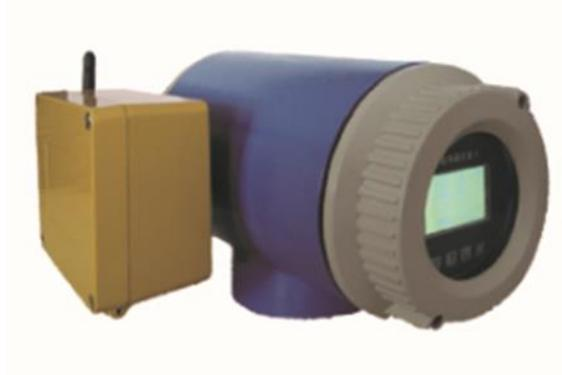
如上图为本公司带无线远传通讯功能的转换器，现场无需布置通讯线材，省去布线费用。此款转换器支持433MHz、2.4Hz、GPRS/CDMA等多种无线通讯模式，可以进行局域或广域的无线流量测量数据的传输和监控。
